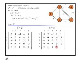
Floyd-Warshall(G = (V,E,W)): d0 = W // initialize with edge weights for k = 1 to V for i = 1 to V for i = 1 to V  $dijk = min(dij^{k-1}, dik^{k-1} + dkj^{k-1})$ k = 2k = 31 2 3 4 5 1 2 3 4 5 0 4 −1 ∞ 9 0 2 -1 1 1 ∞ 0 ∞ ∞ 5 ∞ 0 ∞ ∞ 5 ∞ 3 0 **2** 2 3 ∞ 3 0 2 2 ∞ ∞ ∞ 0 −3 ∞ ∞ ∞ 0 -3 ∞ ∞ 1 ∞ 0 5 ∞ 4 1 3 Found a shorter path! minimum
